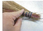
5 3束目以降も同様に巻いていき、最後の束が終わったら、糸を結ぶ。
